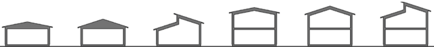
Yksikerroksinen rakennus, kattokulmat 1:5 ja 1:3
