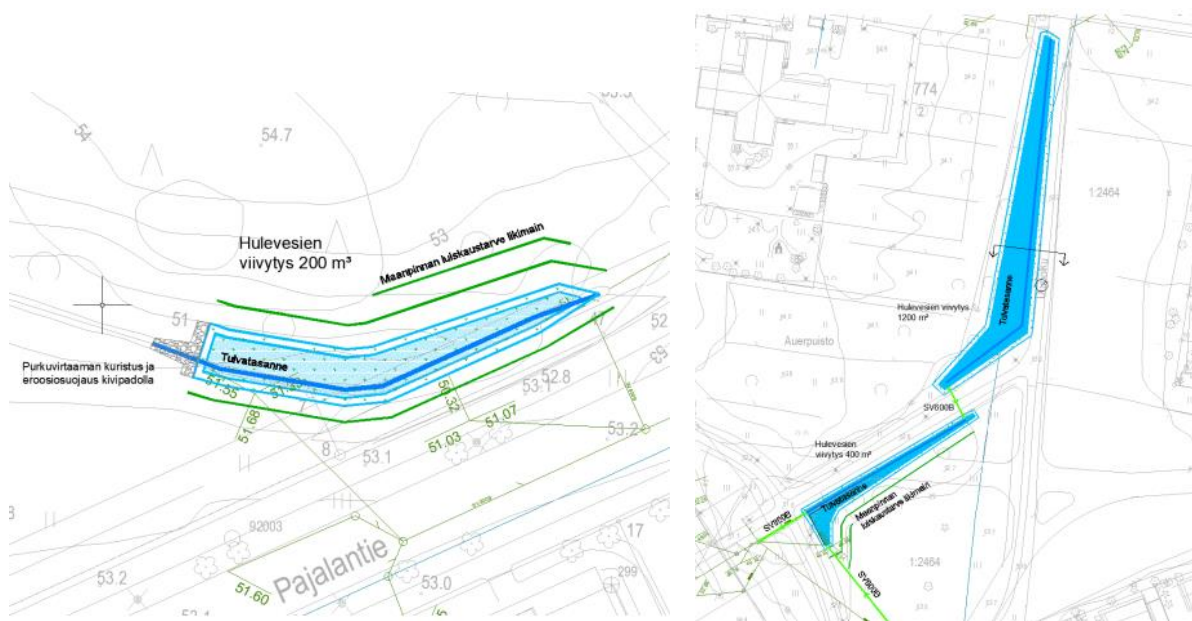
Kuva 6. Hulevesiselvityksessä (2019) todettu hulevesien viivytystarve Pajalantien pohjoispuolella Iltapuistossa ja Pohjoisväylän itäpuolella
