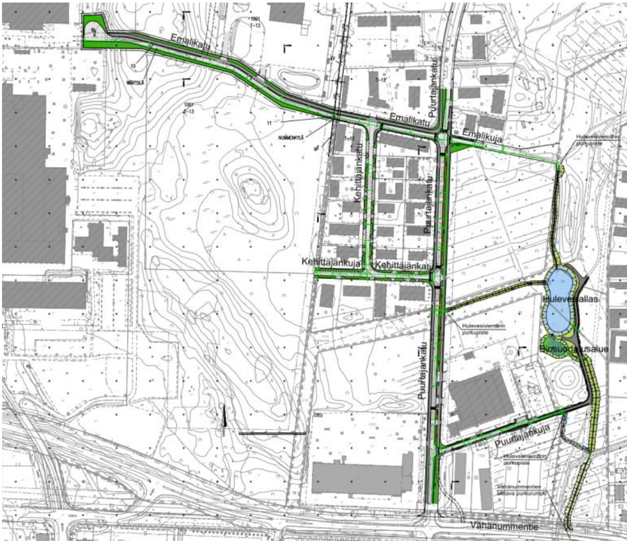
Kuva 6. Hulevesialtaan ja biosuodatusrakenteen sijainti Wärtsilän teollisuusalueella.
