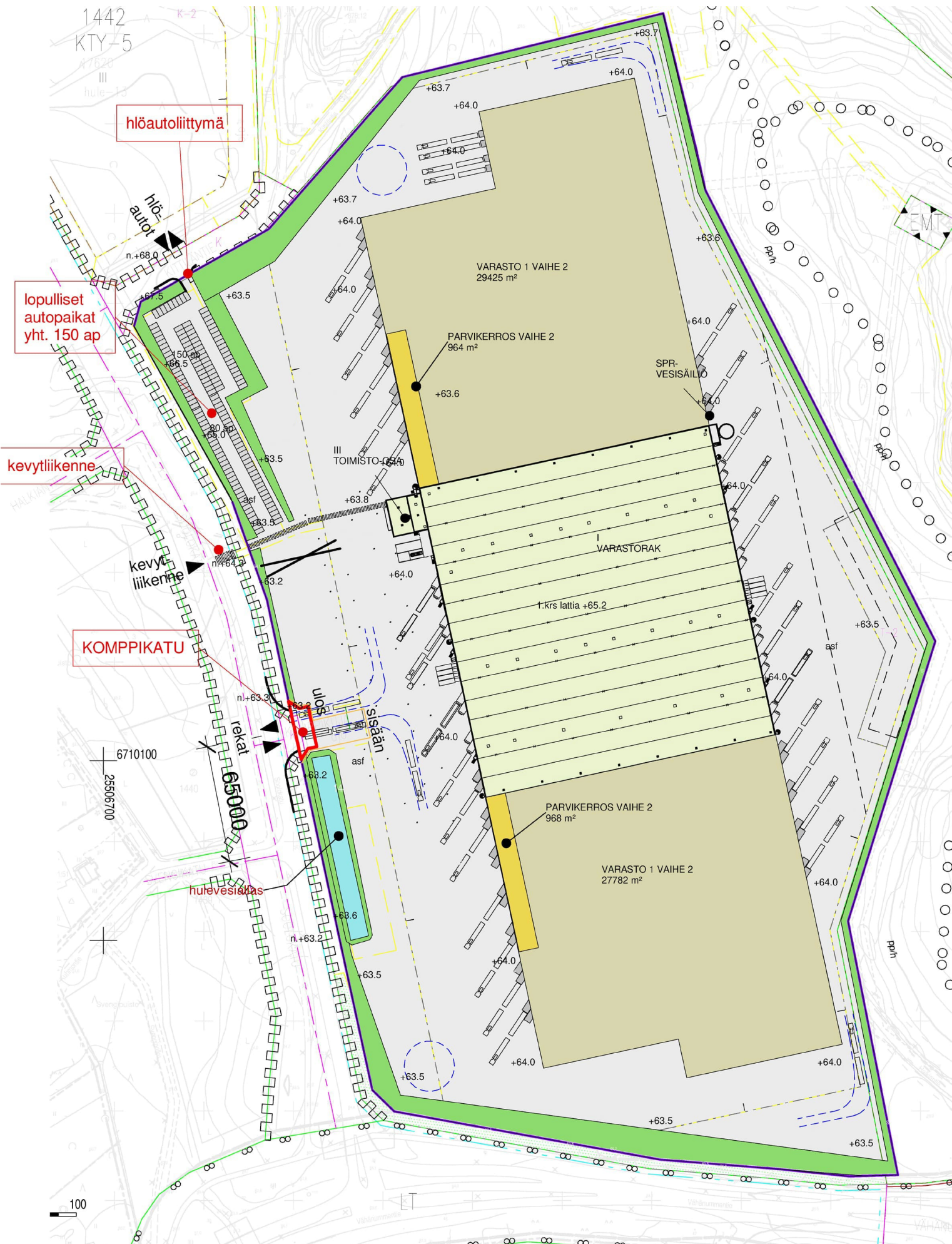
Kolmannessa vaiheessa rakennus, piha-alueet, pysäköintipaikat ja hulevesien viivytysrakenteet on toteutettu kokonaan. Kuva: Arkkitehtitoimisto Siltanen ja Laakso Oy 17.10.2023
